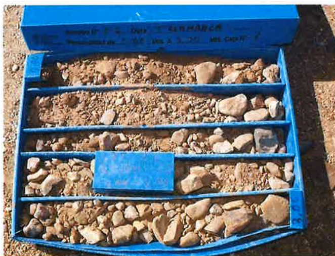
Fotografía 7: Unidad Qca-Conos Aluviales. Sondeo S-2. Caja 1 de 0,00 a 3,00 m.
