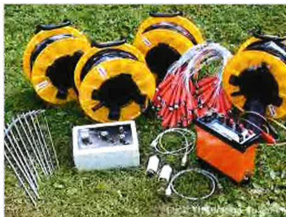
Figura 3.1.-Terrámetro SAS-1000 de ABEM empleado en la campaña de campo.
