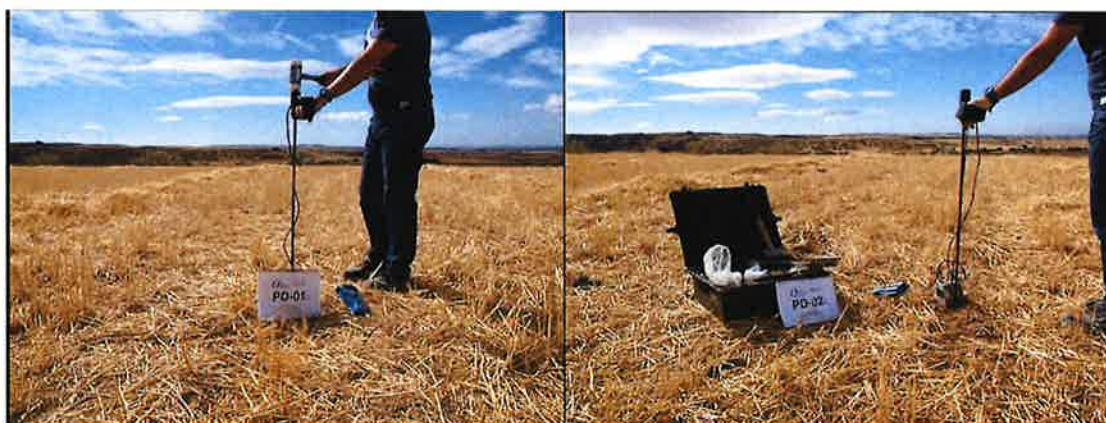
Fotografía 5: Ensayos de penetración dinámica de comprobación ejecutados.
