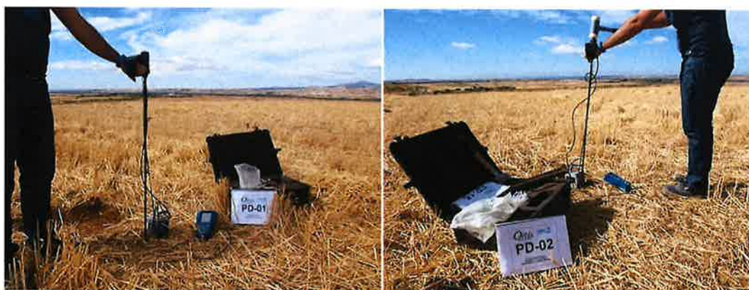
Fotografía 4: Ensayos de penetración dinámica ejecutados.
