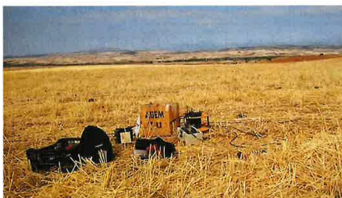
Fotografía 3: Realización de perfil de tomografía eléctrica
